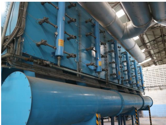
รูปที่ 2.1-6 วาล์ววัดความดันของถังกรอง
